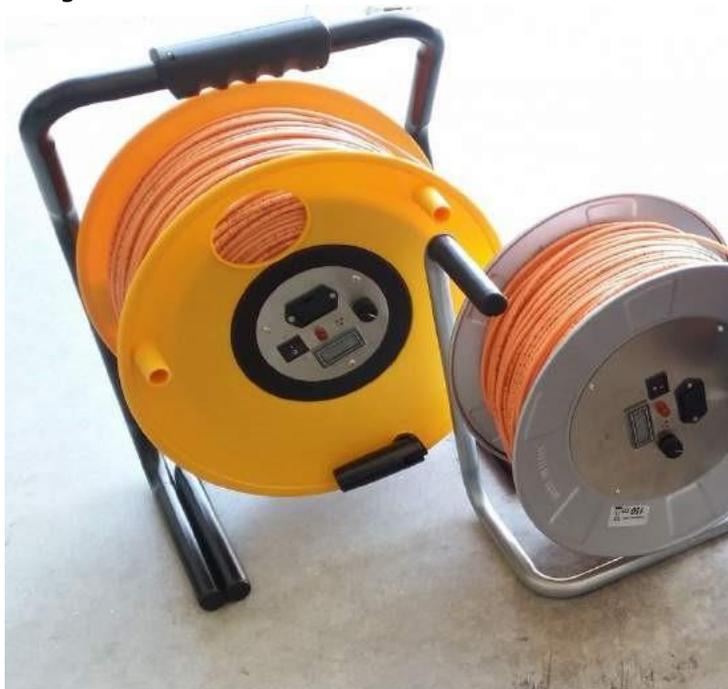
DRAWINGCAD SRL produce anche la versione con sensore di temperatura integrato nel puntale. La presenza del display per la visualizzazione della temperatura e del dispositivo di segnalazione di raggiungimento del fondo del pozzo (fornito a richiesta), insieme alla semplicità di utilizzo, fanno di questo modello uno strumento versatile e conveniente per le misure di livello e temperatura in qualsiasi tipo di pozzo.
